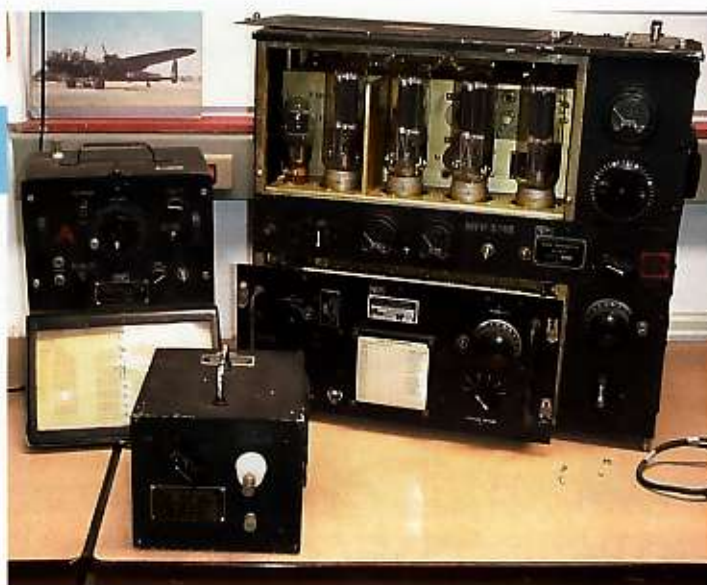
De BC-375 "Liasion" zender met daarnaast de frequentiemeter BC-221 en ervoor de kunstantenne A-58.
